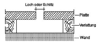
Der Luftpfropfen in den Löchern wird durch die auftreffenden Schallwellen zum Mitschwingen angeregt.
