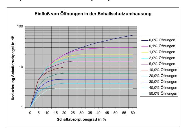
Aus der Grafik ist zu erkennen, dass eine Schallschutzumhausung mit einem theoretischen Schallabsorptionsgrad von 50%
