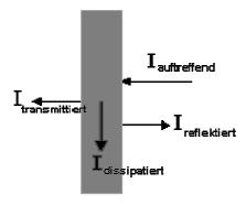
Die Erhöhung der Schallabsorption in einem Raum führt zur Minderung des Schalldruckpegels im Raum.
